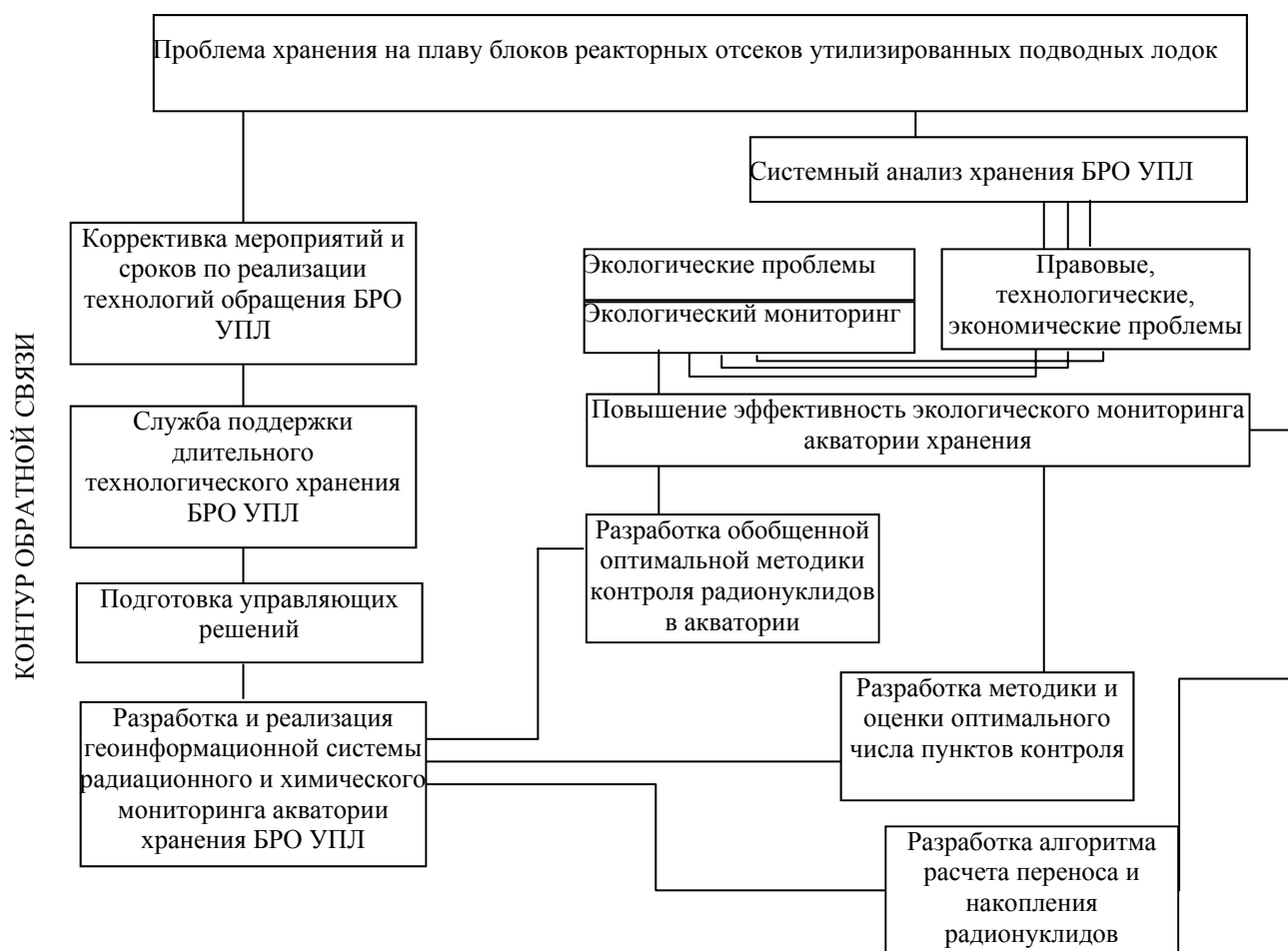
Рис. 2. Блок-схема системного анализа экологических проблем хранения блоков реакторных отсеков (БРО) утилизированных подводных лодок (УПЛ).
